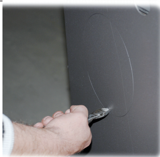
Fig. 1 Knip met een zijsnij- tang het kleine stuk metaal door dat het deksel met de ach- terplaat verbindt. Draai daarna het deksel eraf.
