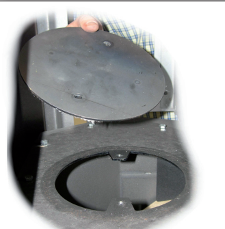
Fig. 9 Plaats het deksel van de achterafvoer op de bovenzijde van de kachel.
