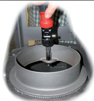
Fig. 4 Draai de bouten in de rookkraag van bovenaf los.
