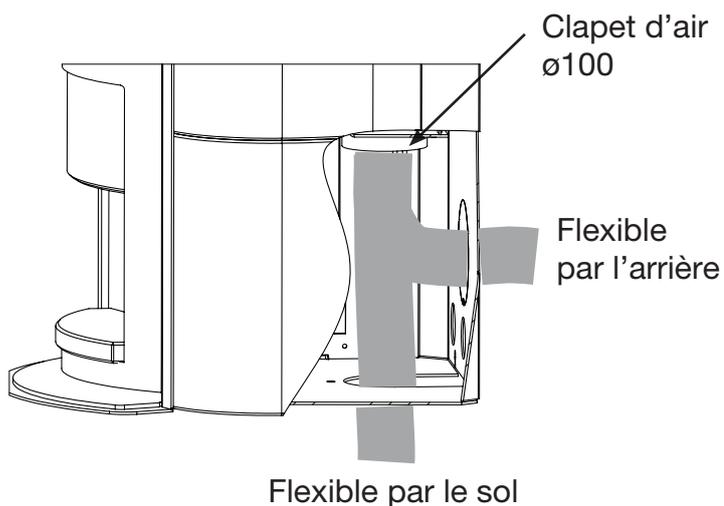
Lors de l'installation d'une alimentation en air externe, un tuyau flexible de contrôle de l'air peut être installé à la sortie d'air derrière le four.
