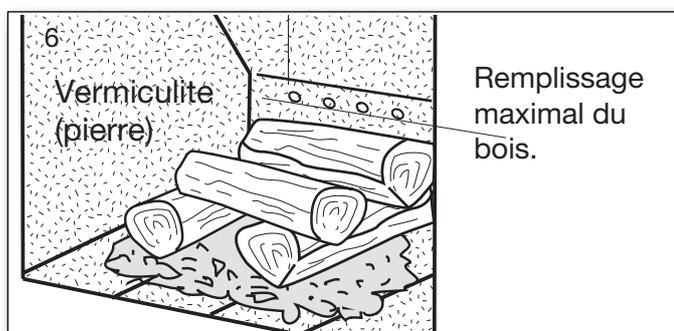
**Lors du rechargement, les bûches doivent être placées avec précautions dans la chambre de combustion car il y a un risque d'endommager la vermiculite (les plaques du foyer).**
