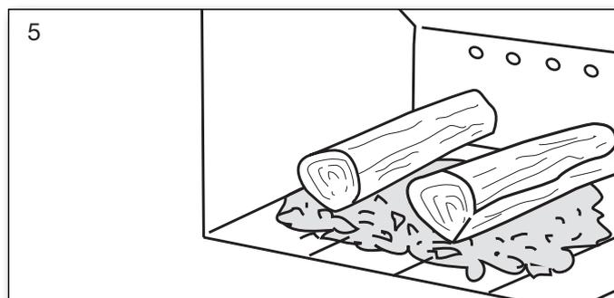
Placer une couche de bûches env. 1,2 kg sur les braises, perpendiculairement à la porte de chargement.
