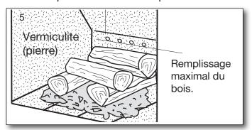
Le chargement du bois doit être maintenu en dessous de la rangée supérieure des orifices d'admission d'air et entre les orifices terminaux, de chaque côté. Fig. 5.
