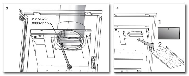
Pour l'installation de la sortie de fumée à 45° vers l'arrière, tourner le raccord de fumée de 180°.
