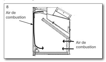
Pour obtenir une combustion optimale et le meilleur rendement possible, le poêle est conçu de manière à ce qu'il produise lui-même une combinaison optimale de l'air de combustion. On obtient ainsi un rendement élevé et la vitre reste propre car l'air secondaire élimine la suie.
