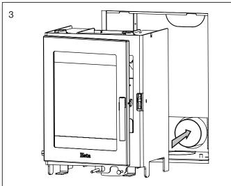
Avec l'option air frais externe par l'arrière, 1511-0030 doit être monté avant de placer le poêle à l'intérieur.
