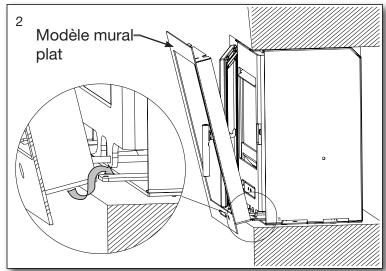
Illustration du modèle mural plat. Le montage est applicable pour les quatre modèles.
