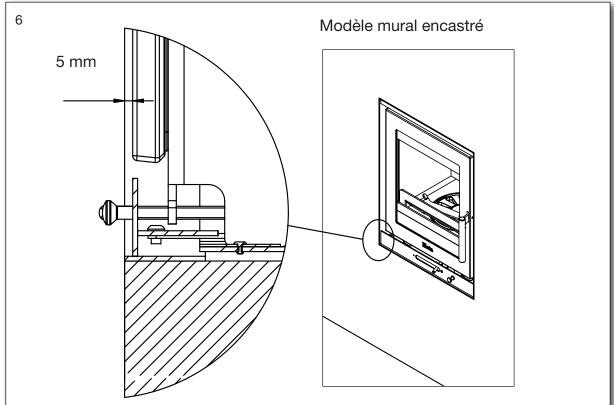
Le devant du support avant doit être à niveau avec l'avant de la porte. Modèle mural encastré, voir fig. 6.
