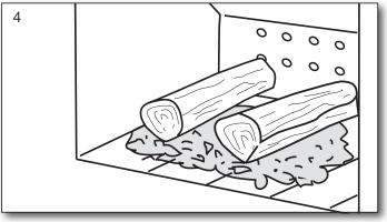
Placer une couche de bûches env. 1 kg sur les braises, perpendiculairement à la porte de chargement.
