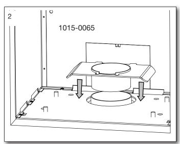
Avec l'option entrée d'air externe par le bas, 1015-0065 doit être monté avant de placer le poêle à l'intérieur.
