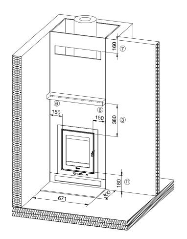
Les matériaux utilisés pour le test de sécurité et reproduits dans les illustrations ci-dessous, comme au point 8, ont une conductivité thermique maximale (=<0,36 W(m\*K).
