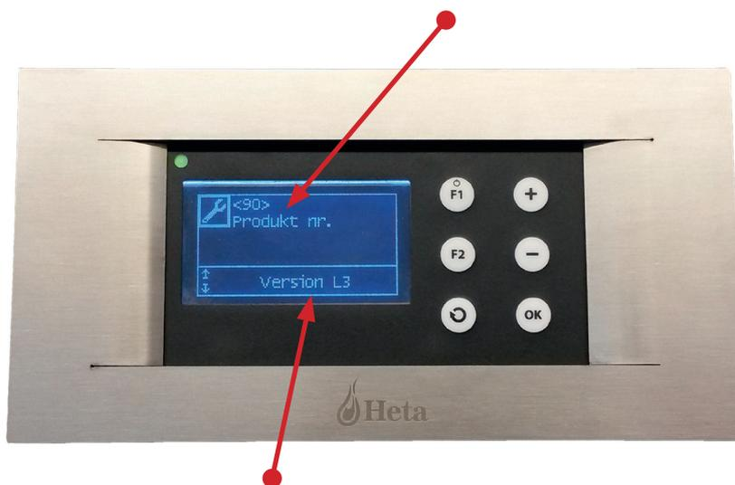
Appuyer sur le bouton « Ok » et « Version L5 » clignotera. Sélectionner ensuite le « Niveau » correct avec le bouton « + » ou « - ». Confirmer avec « Ok ».
