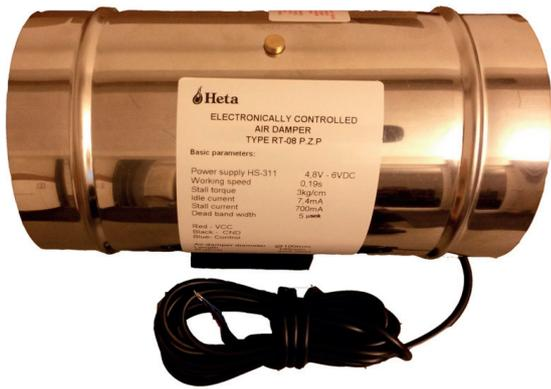
Installer le registre d'air et le tuyau sur l'embout d'admission d'air avec le fil vers le bas et l'arrière. Le boîtier électronique doit toujours être orienté vers l'arrière. Réduire la charge pesant sur les deux fils en attachant ces derniers aux plaques d'ancrage.
