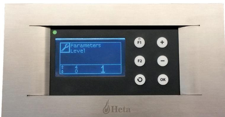
Pour accéder au menu supérieur, appuyer 3 fois sur le bouton « Sélectionner / Changer ». Appuyer ensuite sur le bouton « Ok / Entrer ». Le chiffre 0 clignotera alors. Appuyer sur le bouton « + » pour obtenir 1 et confirmer en appuyant sur le bouton « Ok / Entrer ». Appuyer 2 fois sur le bouton « Sélectionner / Changer » pour afficher « Langue » sur l'écran (voir ci-dessous).
