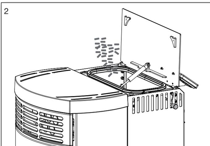
Le sac de granulés de bois ne doit pas être placé sur la bande d'étanchéité lors du remplissage des granulés de bois.
