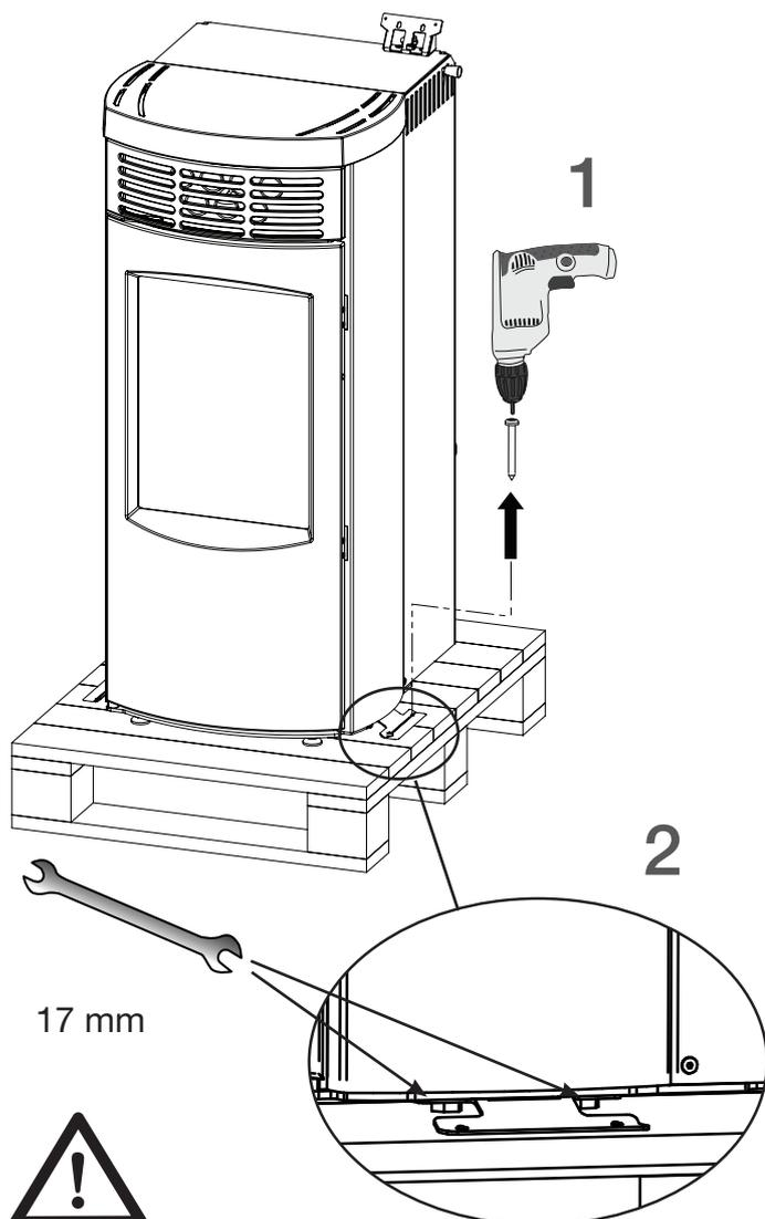
**Les boulons doivent seulement être desserrés, puis support de transport amovible puis serrez à nouveau.**
