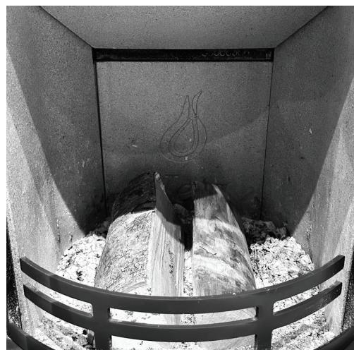
Placer une couche de bûches env. 1,24 kg sur les braises, perpendiculairement à la porte de charge. Ouvrir complètement l'entrée d'air de combustion.
