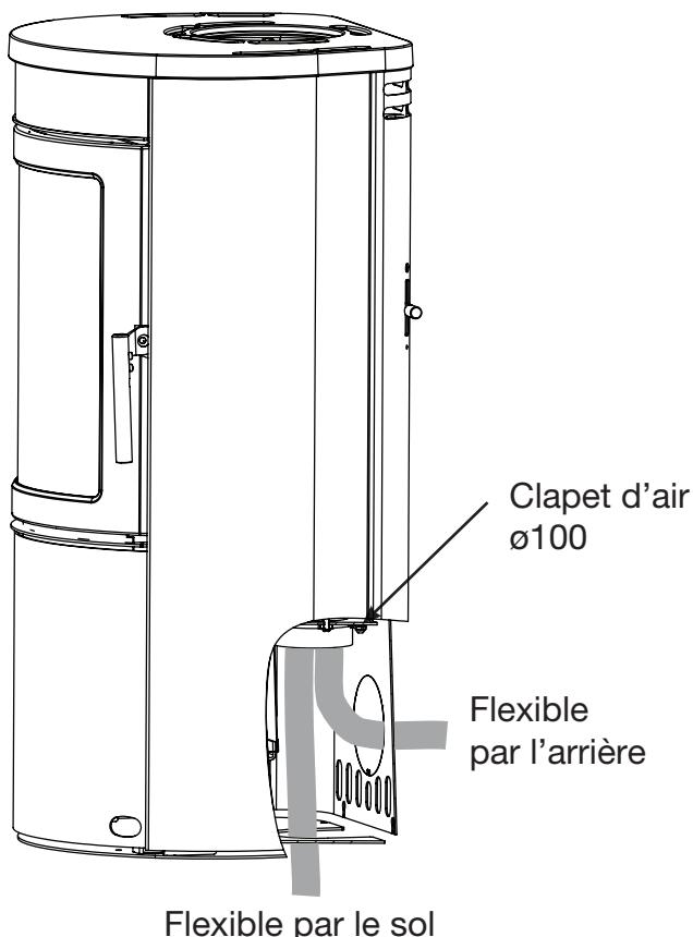
Lors de l'installation d'une alimentation en air externe, un tuyau flexible de contrôle de l'air peut être installé à la sortie d'air derrière le four.
