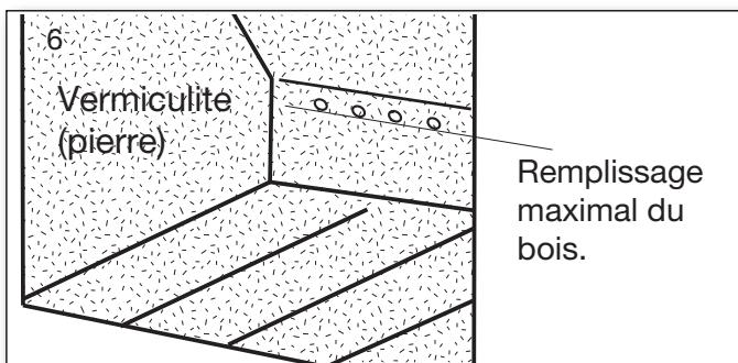
**Lors du rechargement, les bûches doivent être placées avec précautions dans la chambre de combustion car il y un risque d'endommager la vermiculite (les plaques du foyer).**
