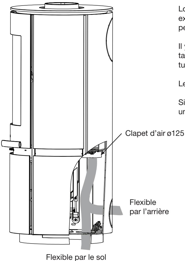
Lors de l'installation d'une alimentation en air externe, un tuyau flexible de contrôle de l'air peut être installé à la sortie d'air derrière le four.
